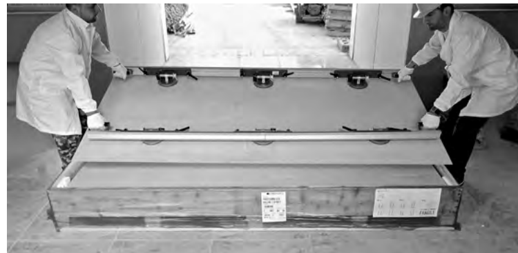
Telaio in alluminio con ventose, facile da trasportare perché scomponibile
